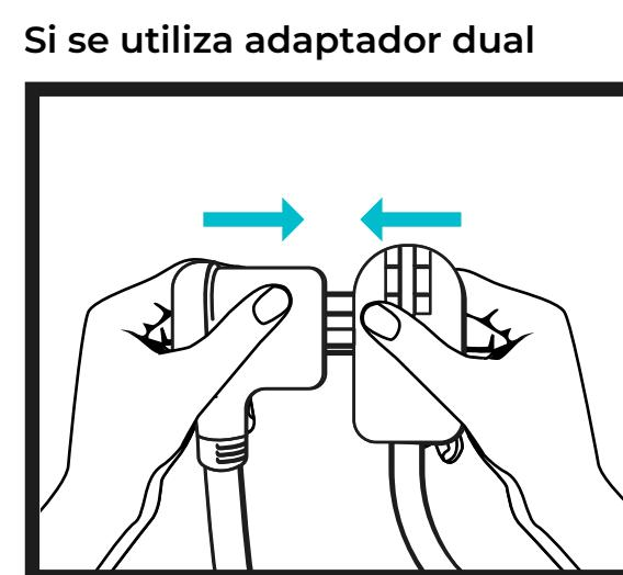
Acople el **adaptador** con el **enchufe de alimentación** de la estación de carga
